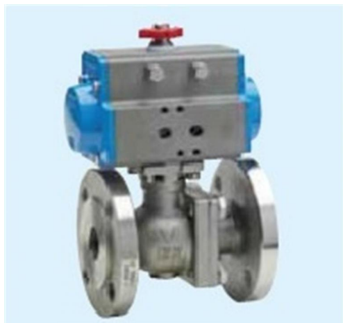
2-Wege-Flansch-Kugelhahn PN16, Edelstahl, voller Durchgang, mit Antrieb
